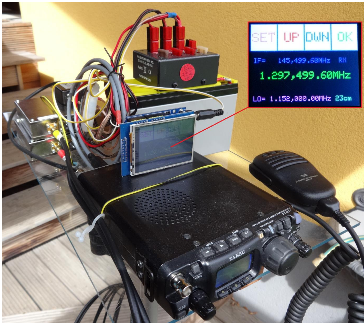
Bild oben: Der Display-Prototyp ohne Gehäuse am FT-817ND
